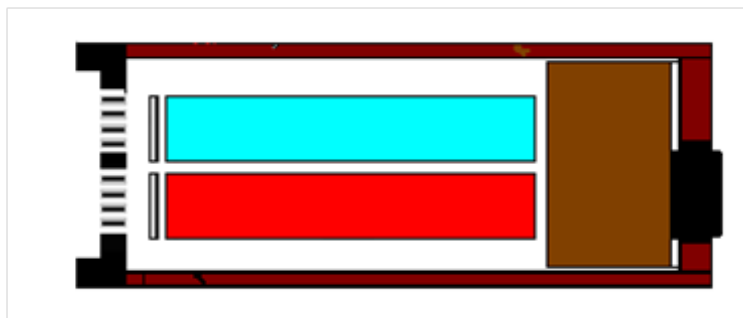
Рис. 2.2: Схема детекторов УФ и ИК излучения, установленных на борту спутника «Вернов».
