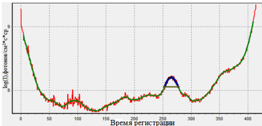
Рисунок 2.5.3 Диалоговое окно программы. Вертикальная ось – логарифм интенсивности, горизонтальная – время регистрации (один шаг равен 4.5 с)
