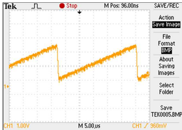
Рис. 2.2.6. Осциллограмма выходного напряжения ЦАП в ходе тестирования модуля управления высоким напряжением МАФЭУ (пример пилообразного сигнала)
