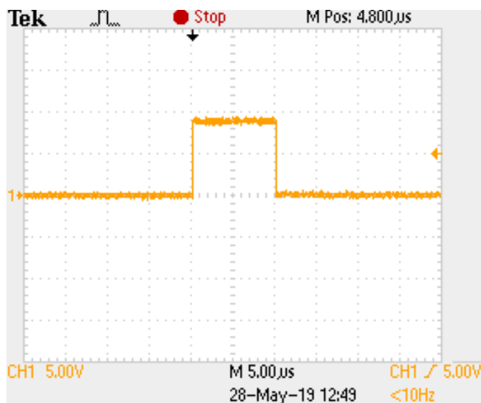
Рис. 3.2.4. Импульсный сигнал, подаваемый на светодиод. Период сигнала 400 мкс
