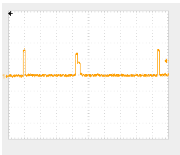
Рис. 5.12 Осциллограмма прямоугольного импульса длительностью 1 мкс.
